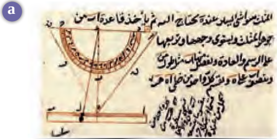
Görsel 2.18: Abdurrahman Hazini'nin yıldızların yüksekliklerini ve bir nesnenin bize görüldüğü optik açıyı belirlemek için tasarlamış olduğu üçgenli aletin eserindeki çizimi (a) ve aletin özgün biçimiyle yeniden tasarlanmış hâli (b)
