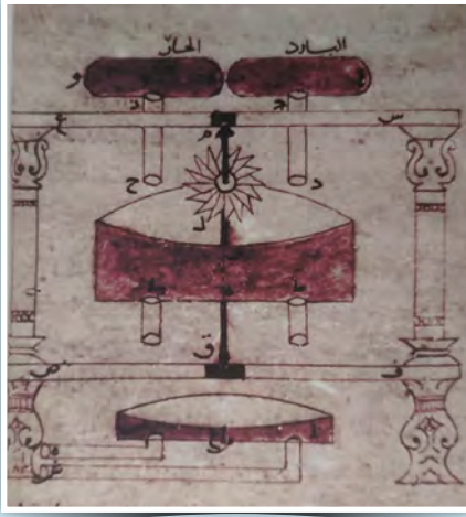
Görsel 2.38: Sıcak ve Soğuk Suyu Sırayla Veren Otomat Görseli. Benî Musa Kardeşler'in Kitâbü'l- Hiyel adlı eserinden alınmıştır. Topkapı Sarayı Müzesi, İstanbul
