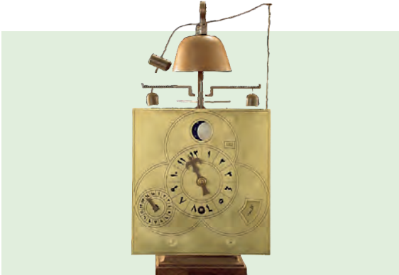
Görsel 5.21: Takıyyüddin'in yaptığı zemberekli çalar saat
