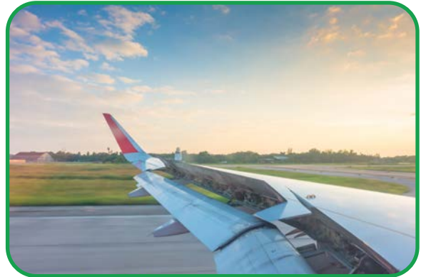
Görsel 2.3.23: Flapları açık uçak kanadı
