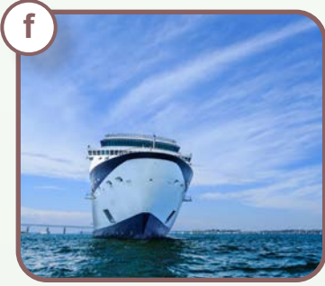
Gemilerin ön kısmının "V" şeklinde tasarlanması
