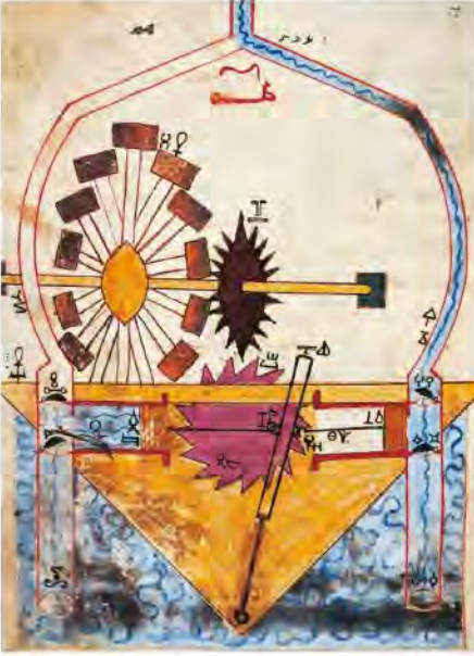
Suyu yukarı taşıma düzeneği taslak çizimi, Cezeri
